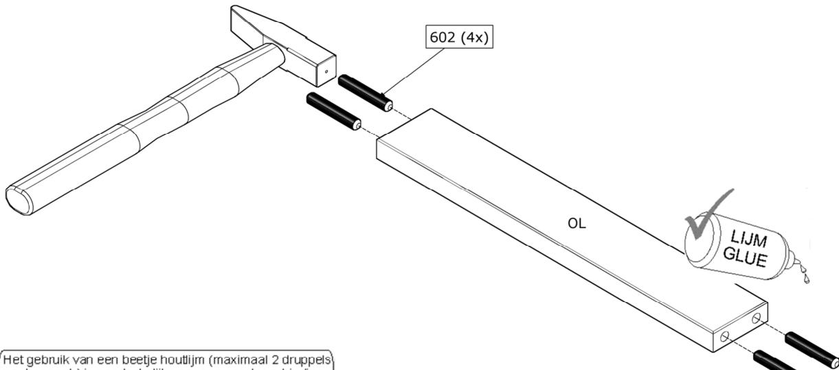
Het gebruik van een beetje houtlijm (maximaal 2 druppels per boor gat ) is noodzakelijk voor een goede verbinding.
