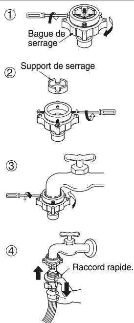
1. Dévissez la bague de serrage de l'adaptateur et les 4 vis de fixation de l'adaptateur.
