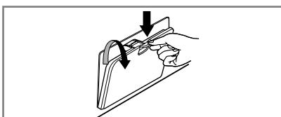
1. Afdekkap openen. Afvoerschroef losmaken. Slang eruit trekken.
