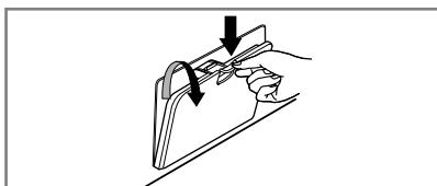
1. Ouvrez la trappe d'accès en positionnant en-dessous un récipient qui collecte l'eau s'en éoulant. Tirez le tuyau.
