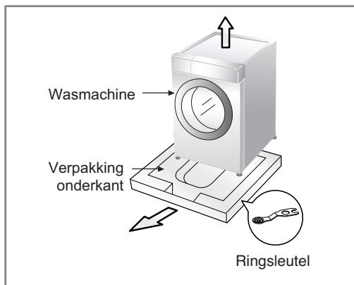
1. Verwijder de kartonnen verpakking van de wasmachine en piepschuim verpakking.
