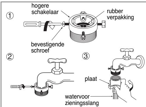
1. Schroef het adapterringplaatje en de vier bevestigingsschroeven van de adapter los.
