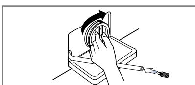
4. Une fois le nettoyage terminé, remettez le filtre en place en le revisant.
