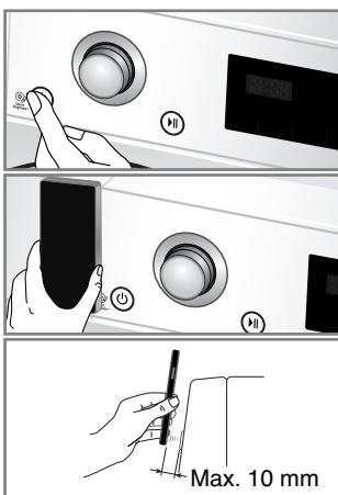
**1.** Druk op de aan/uit knop om de wasmachine aan te zetten.
