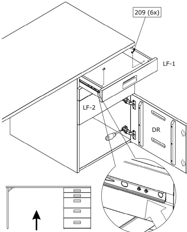
A. Deze schroef gebruiken wanneer u de kieren tussen de deuren en beide zijden groter of kleiner wilt hebben.
