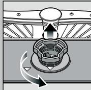
Zeefcilinder eruit draaien, zeefstelsysteem eruit halen ...
