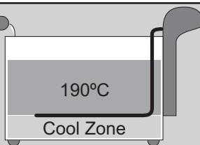
Ce type de friteuse, est uniquement utilisable avec de l'huile ou de la graisse liquide, et non avec de la graisse solide.
