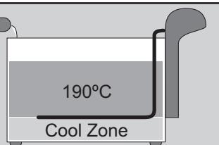
Dieser Cool Zone Frittier-Typ darf nur mit Öl oder anderen flüssigen Fetten benutzt werden, d.h. nur mit nicht hartwerdenden Fetten. Bei hartwerdenden Fetten kann Wasser eingelagert werden und dann beim Erhitzen herausgespritzt werden.
