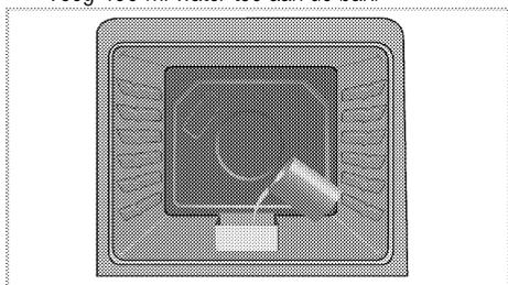
3. Stel de oven in op gemakkelijke stoomreinigingsmodus en laat deze gedurende 25 minuten draaien op 200°C.
