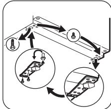
3. Entfernen Sie das untere Türscharnier, indem Sie die zwei Befestigungsschrauben lösen.
