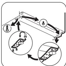
3. Verwijder het onderste deurscharnier door de twee bevestigingsschroeven los te draaien.
