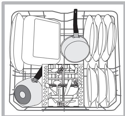
Doporučuje se umístit značně znečištěné nádobí do spodního koše, protože v této části myčky jsou proudy vody nejsilnější a umožňují dosáhnout nejlepších výsledků mytí.
