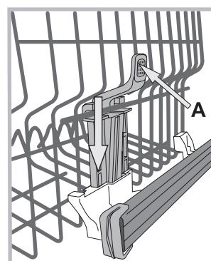
Když je koš vybaven systémem **Lift-Up\*** (viz obrázek), zvedněte koš po jeho uchopení na bocích a pohněte jím směrem nahoru. Pro návrat do spodní polohy stiskněte páky (A) na bocích koše a doprovoděte jej při sestupu směrem dolů.
