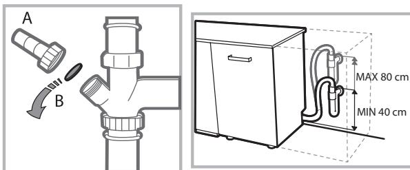
Перед подсоединением сливного шланга к сифону мойки снимите пластиковую пробку (B).
