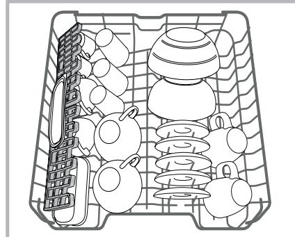
В некоторых моделях посудомоечных машин имеются откидные секции\*, используемые в вертикальном положении для размещения чайных блюдц или десертных тарелочек или в опущенном положении для размещения мисок и пищевых коробок.
