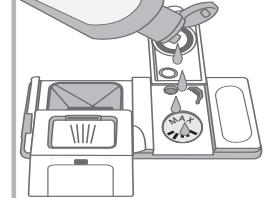
1. Откройте дозатор "D", нажав на язычок на крышке и подняв его;
