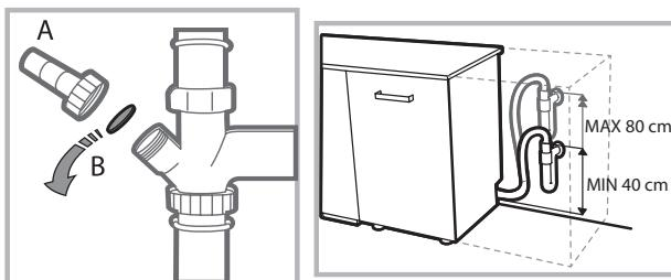
Voordat u de waterafvoerbuis aansluit op de sifon van de wasbak, moet u de plastic dop (B) verwijderen.
