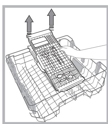
Horní koš je výškově nastavitelný dle potřeby: do horní polohy kvůli umístění neskladného nádobí; do spodní polohy kvůli využití prostoru sklopných nebo naklonitelných držáků a vytvoření většího prostoru směrem nahoru.
