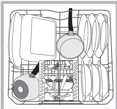
Рекомендуется разместить сильно грязную посуду в нижней корзине, так как в этой части струи воды более сильные и обеспечивают оптимальную мойку посуды.
