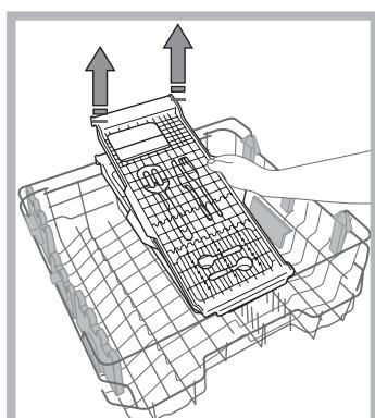
Het bovenrek kan naar believen in hoogte worden aangepast: naar boven toe als men in het onderrek volumineuze vaat wil plaatsen, naar beneden toe om goed te kunnen profiteren van alle plek in de opklaprekjes of de uitklapbare delen, zodat er naar boven toe meer plaats is.
