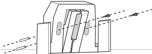
Abbildung 2 Ladestation an der Wand befestigen
