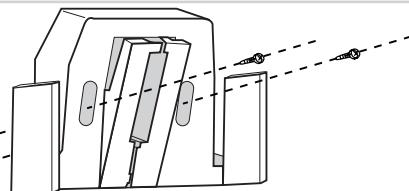
Figura 2 Fissaggio del supporto di ricarica alla parete
