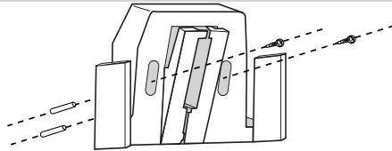
Figuur 2 Oplaadstation aan wand bevestigen
