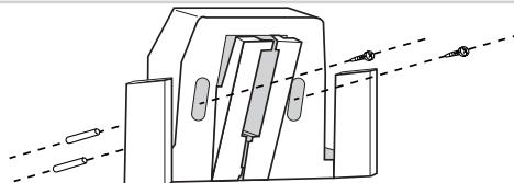
Figura 2 Fijación de la estación de carga a la pared
