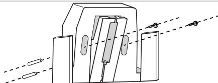
Figure 2 Fixation du socle de recharge au mur
