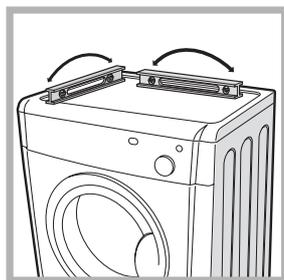
Após ter instalado a máquina de secar roupa na posição definitiva, controle o nível antes de um lado ao outro, e depois de frente para trás.
