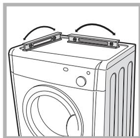
Una vez instalada la secadora en su posición definitiva, controlar su nivelación de lado a lado y luego de adelante hacia atrás.
